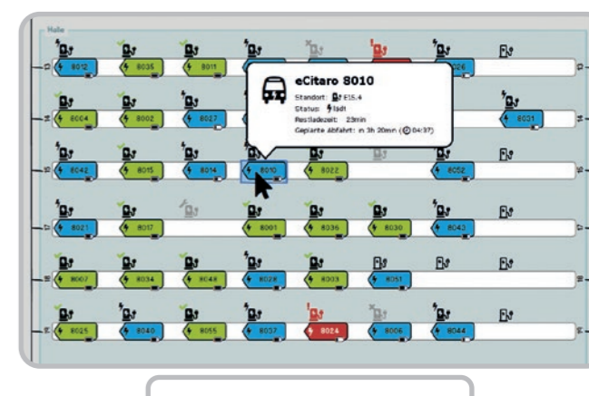
La vista de depósito en IVU.vehicle muestra procesos de carga, asignaciones de estacionamientos y buses en el depósito
