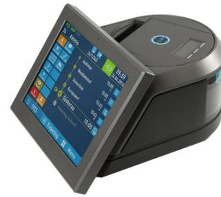
IVU.ticket.box funciona como computador de a bordo y como impresora/terminal de billeteo electrónico. Alimenta al centro de control operacional con información sobre el vehículo, mantiene al conductor bien informado durante el trayecto y le ayuda en la venta de billetes.
